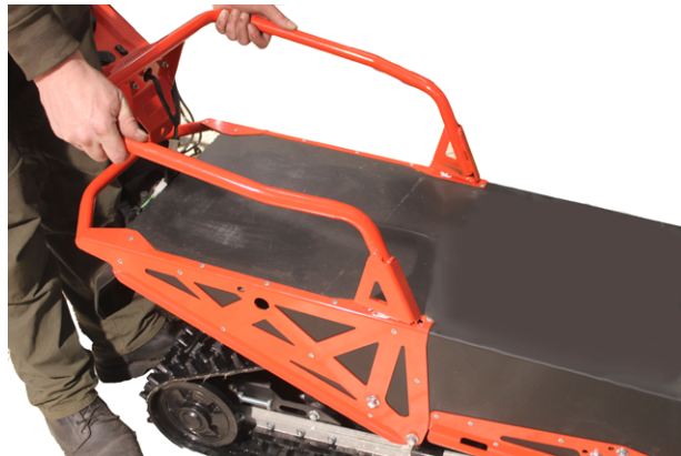
27. Снимаем багажник, потянув на себя и вверх
